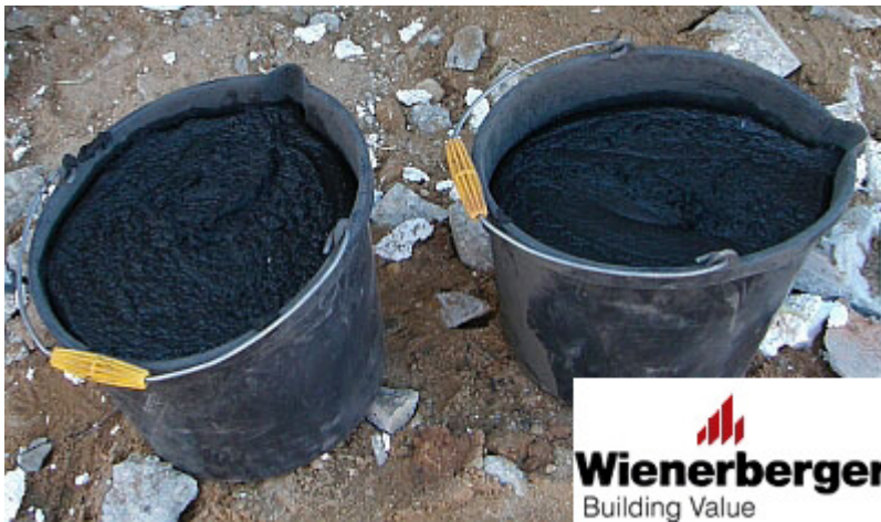
57 pav. Spalvotas sausesnis skiedinys apdailiniam plytų mūriui
